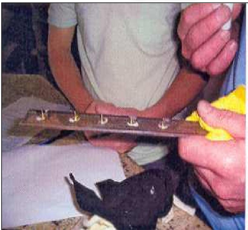
FIGURA 10 - Montagem do experimento sobre condução do calor
