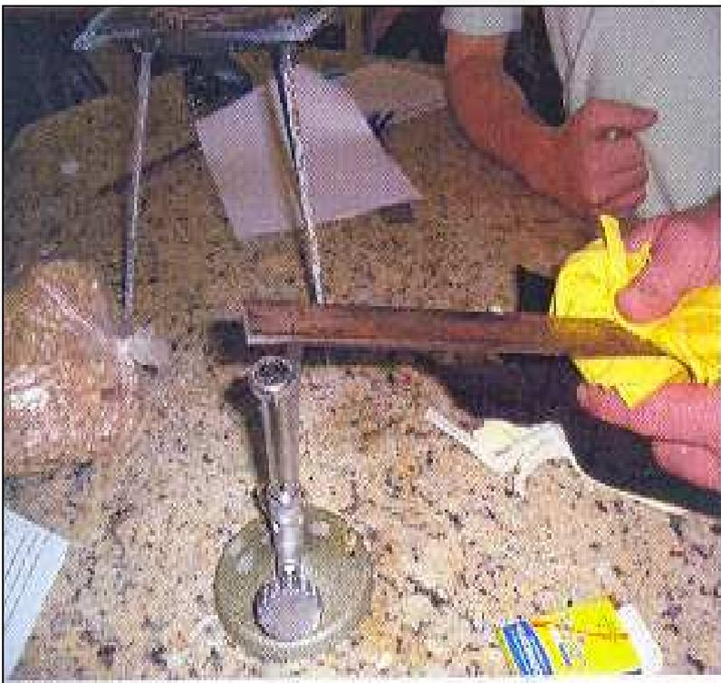
FIGURA 12 - Propagação do calor por condução
