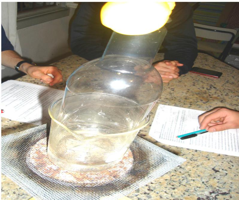
FIGURA 4 – Dilatação do ar com balões de paredes finas
